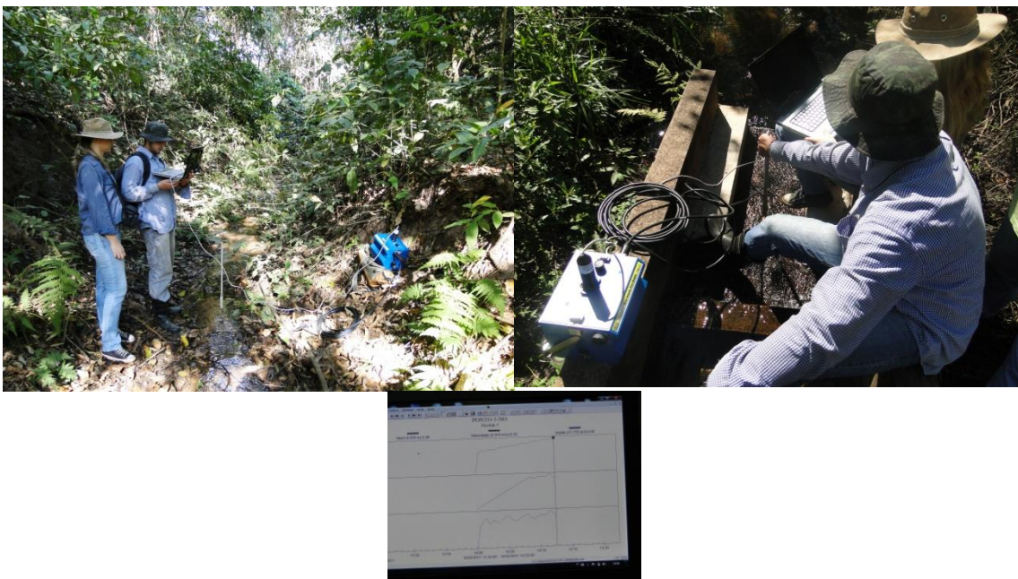
Figura 5. Vista Geral realização leitura da vazão em pontos da rede de drenagem da Microbacia do Córrego da Olaria, Pindorama – SP.
