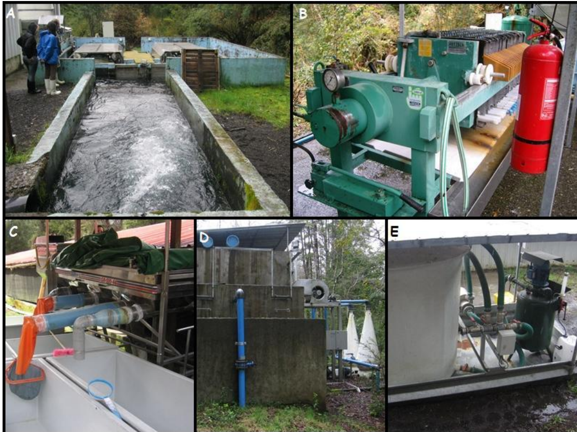
Figura 5. Equipamentos usados na produção de salmonídeos. A – filtro mecânico rotativo que remove os sólidos (restos de ração e fezes) do efluente antes de emití-lo aos corpos d’água receptores; B – Sistema de prensas para confecção de “tortas” dos sólidos extraídos do efluente; C – Classificador automático de alevinos e juvenis em classes de tamanho; D – Recepção da água de abastecimento, com mecanismos de incremento da oxigenação; E – equipamento que tritura os peixes mortos e injeta ácido fórmico para a confecção da silagem, que é enviada à fábrica de farinha de peixe.
